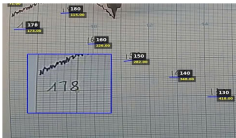
Hình 5. Thuật toán PaddleOCR để đọc mực nước ghi đầu ngày
