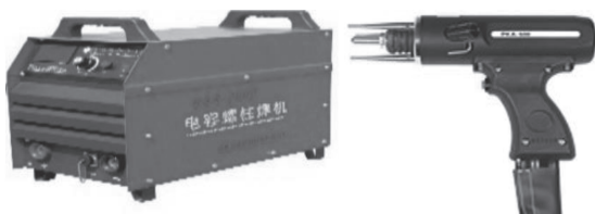
Hình 3. Thiết bị hàn chót ARC [9]
