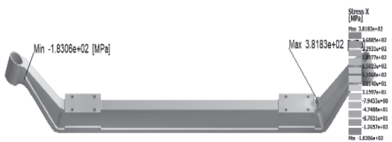
Hình 7: Trường hợp ô tô quá tải 50% quay vòng (Fy1=54320 N; Fy2=46771 N; Fz1=60356 N; Fz2=51958 N)
