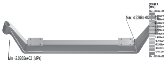
Hình 9: Trường hợp ô tô quá tải 75% quay vòng ( Fy1=60131\text{N} ; Fy2=51775\text{N} ; Fz1=66813\text{N} ; Fz2=57528\text{N} )
