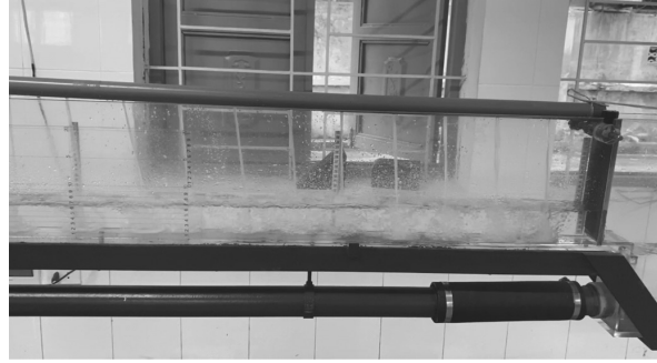
Hình 5. Đoạn ống đục lỗ tạo dòng biến lượng trong máng
