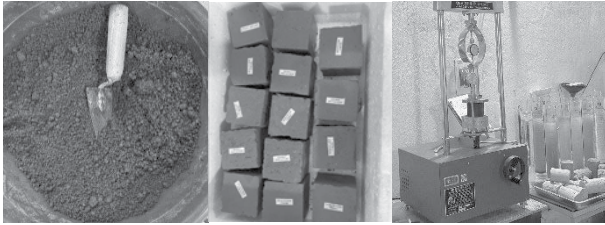
Hình 8. Thí nghiệm nén nở hông các mẫu R-GFM
