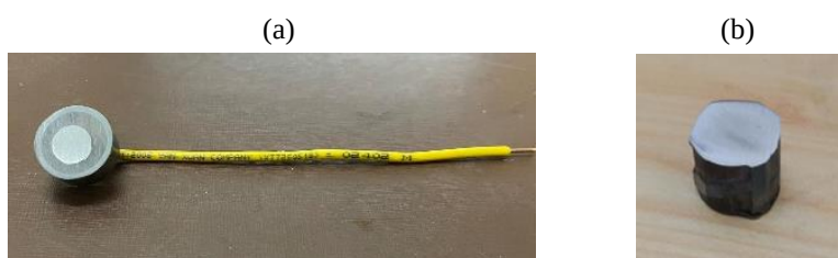
Hình 2. Mẫu thử nghiệm ăn mòn: (a) Dùng cho đo điện hóa; (b) Dùng cho phân tích bề mặt
