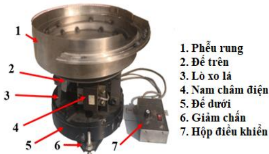
Hình 1. Hệ thống cấp phôi tự động dạng phễu rung
