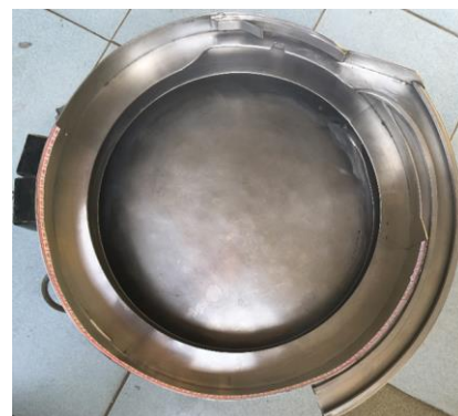
Hình 8. Kênh điều hướng cho nắp chai vaccine trên mô hình thực nghiệm
