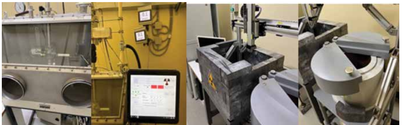
▲ Hình 6. Phổ kế Gamma dùng detector bán dẫn Ge siêu tinh khiết tại lò phản ứng hạt nhân IBR-2
